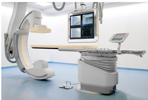
图 9-1 UNIQ FD20 型 DSA 设备外观图
